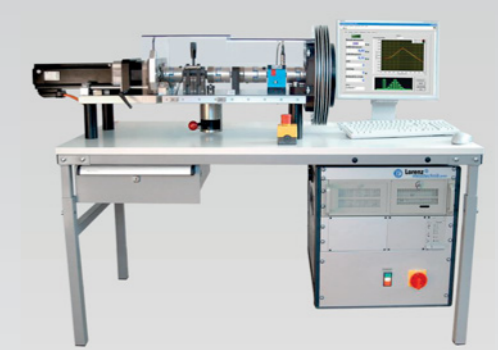
Drehmoment-Kalibriereinrichtung für Tretlager
